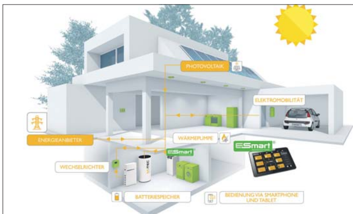
Moderne Wärmepumpen können mit Photovoltaik- und PV-Termie-Anlagen kombiniert werden – eine Lösung für Reihenhäuser, bei denen im Garten kaum Platz für die Anlage zur Verfügung steht. Grafik: M-Tec
